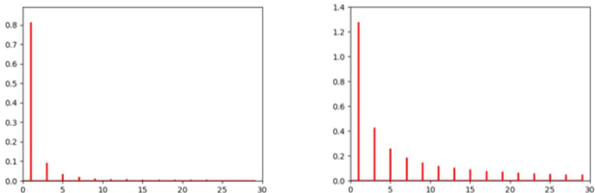
Signal et spectre en amplitude du do<sup>3</sup> d'un guitare
